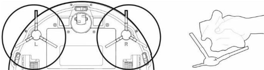
Zkontrolujte dle intenzity znečištění, minimálně jednou týdně, oba boční čistící kartáče společně s otvorem pro nasávání vzduchu a odstraňte z nich namotané vlasy a další nečistoty.
