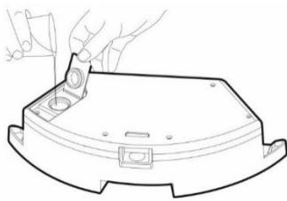
Öffnen Sie die Plastikkappe und sammeln Sie Wasser im Wassertank. Füllen Sie erst Wasser in den Wischbehälter, nachdem Sie den Behälter aus dem Staubsauger genommen haben.
