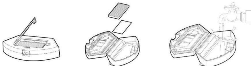
Reinigen Sie den HEPA-Filter je nach Verschmutzungsgrad regelmäßig, mindestens einmal wöchentlich, mit einem Staubpinsel oder saugen Sie ihn mit einem handelsüblichen Staubsauger ab.
