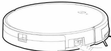
**Zapnutie:** prepnite spínacie tlačidlo do pozície ( **I** )
