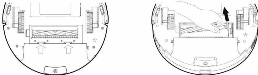
Um die zentrale Hauptreinigungsbürste zu entfernen, drücken Sie beide Laschen an der Bürstenabdeckung. Verwenden Sie ein Reinigungswerkzeug, um Haare zu entfernen, die sich in der zentralen Hauptbürste verfangen haben. Halten Sie die zentrale Reinigungsbürste frei von vielen Haaren, Staub, Baumwolle usw.
