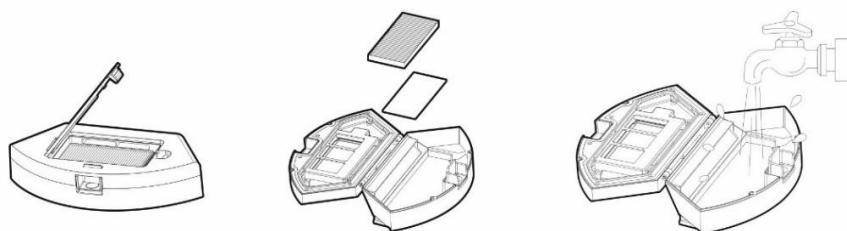
Vyčistite HEPA filter pravidelne podľa miery jeho znečistenia, minimálne raz týždenne, prachovým štetcom alebo vysajte klasickým vysávačom. Nádobu na nečistoty môžete zbaviť prachu čistou vodou.
