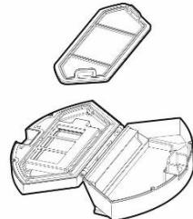
Nyomja meg a portartály kioldó gombot és a szemetet ürtse ki a kukába. Az elsődleges szűrőt ajánlott kéthetente tiszta vízben kimosni.
