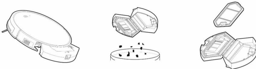
Stlačte uvoľňovacie tlačidlo pre vybratie zásobníka na nečistoty a vysypťte nečistoty do odpadkového koša. Odporúčame umyť „Primárny filter“ čistou vodou každých 14 dní.
