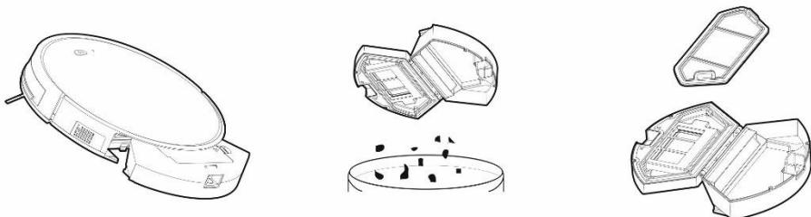
Stiskněte uvolňovací tlačítko pro vyjmutí nádoby na nečistoty a vysypejte nečistoty do odpadkového koše. Doporučujeme umýt „Primární filtr“ čistou vodou každých 14 dní.
