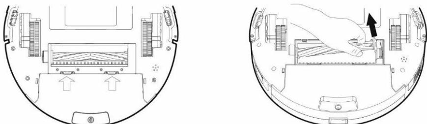
Aby usunąć główną środkową szczotkę czyszczącą, naciśnij obie wypustki na osłonie szczoteczki. Za pomocą narzędzia czyszczącego usuń włosy zaplątane w główną szczotkę. Centralną szczotkę czyszczącą należy chronić przed dużą ilością włosów, kurzu, bawelny itp.
