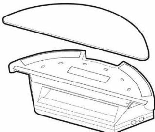
A kék törlökendőt helyezze a víztartály aljára. Gyorsabb és hatékonyabb tisztítás érhető el, ha a kendőt enyhén benedvesítjük. A törlökendő eltávolításakor ügyeljen, hogy a rögzítő tépőzár ne sérüljön meg. Tisztítás után az elkoszolódott törlökendőt langyos vízben mosza ki.
