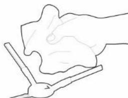
Curățați regulat filtrul HEPA în funcție de gradul de contaminare, cel puțin o dată pe săptămână, cu o perie de praf sau aspirați-l cu un aspirator standard.
