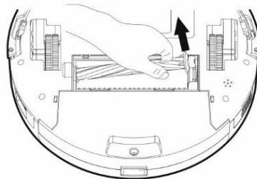
Hlavnú stredovú čistiacu kefu vyberte stlačením oboch úchytiel na kryte kefy. Na odstránenie vlasov zamotaných do hlavnéj kefy použite čistiaci nástroj. Udržujte stredovú čistiacu kefu bez väčšieho množstva vlasov, prachu, bavlny apod.
