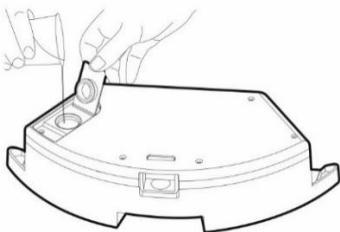
Deschideți capacul din plastic și turnați apă în rezervorul de apă. Turnați apa în rezervorul de apă numai după scoaterea rezervorului din aspirator. La manipularea cu rezervorul de apă, poate avea loc o ușoară scurgere de ex., de apă reziduală. În acest caz, ștergeți imediat zona udată cu o cârpă uscată.
