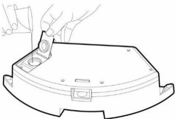
Odklopte plastovou krytku a naberte vodu do zásobníku na vodu. Vodu do nádobky pro vytírání vodou doplňujte výhradně po vyjmouti nádobky z vysavače. Při manipulaci s nádobkou pro vytírání vodou může dojít k mírnému úniku např. zbytkové vody. V takovém případě polité místo ihned utřete suchým hadrem. Doporučujeme podlahu stírat čistou vodou, čisticí prostředek může způsobit napěnění a zhoršit tak odkapávání vody na mop nebo způsobí šmouhy na podlaze, po jejím uschnutí.
