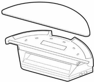
Nainstalujte modrou mopovací tkaninu na spodní díl zásobníku na vodu. Lehce navlhčete vodou mopovací tkaninu pro rychlejší a plynulejší stírání vodou. Při sundávání mopu z držáku postupujte opatrně, abyste rychlým pohybem nepoškodili suchý zip na držáku. Pokud je mop po úklidu špinavý, můžete jej opatrně vyprat ve vlažné vodě.
