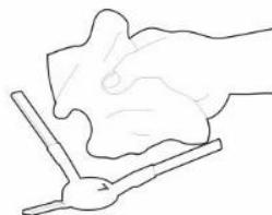
Skontrolujte podľa intenzity znečistenia, minimálne raz týždenne, oba bočné čistiacie kefy spoločne s otvorom pre nasávanie vzduchu a odstraňte z nich namotané vlasové a ďalšie nečistoty.
