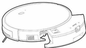
Opatrně zasuňte zásobník na vodu do těla robotického vysavače. Nepolijte robotický vysavač nebo jeho vnitřní část vodou, vysavač není vodotěsný. Připojte jej do nabíjecí stanice. Chcete-li dosáhnout co nejlepšího výsledku při stírání vodou, doporučujeme používat tuto funkci v jedné místnosti a poté se přesunout do další místnosti.
