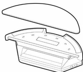
Postavite mokru krpu za brisanje na donji dio spremnika za vodu. Navlažite malo krpu za brisanje vodom za brže i neometanje brisanje. Pažljivo skidajte krpu s držača da ne biste brzim pokretom oštetili suhu traku na čičak na držaču. Ako je krpa nakon čišćenja prljava, možete ju pažljivo oprati u vodi.
