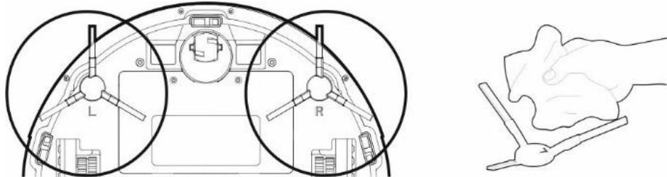
Mindestens einmal pro Woche beide seitlichen Reinigungsbürsten zusammen mit der Luftansaugöffnung je nach Intensität der Verschmutzung kontrollieren und verhedderte Haare und andere Verschmutzungen entfernen.
