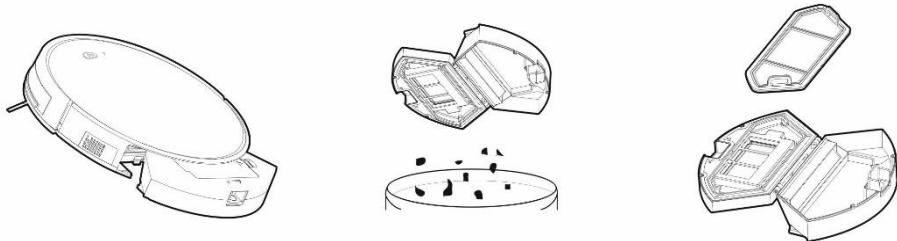
Drücken Sie die Entriegelungstaste, um den Staubbehälter zu entfernen und den Schmutz in den Abfallbehälter zu entleeren.
