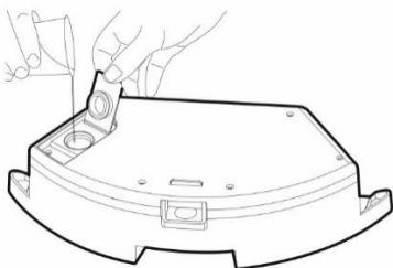
Otklopite plastični poklopac i ulijte vodu u spremnik za vodu. Dodajte vodu u spremnik za brisanje vodom samo nakon što ste spremnik izvadili iz usisavača. Pri rukovanju spremnikom za brisanje vodom može doći do laganog curenja, npr. ostatka vode. U tom slučaju poliveno mjesto odmah obrišite suhom krpom. Preporučamo brisanje poda čistom vodom jer se sredstvo za čišćenje može pjeniti i tako pogoršati kapanje vode na krupu za brisanje ili uzrokovati mrlje na podu nakon sušenja.
