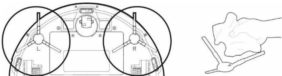
Co najmniej raz w tygodniu sprawdzać szczotki czyszczące z obu stron wraz z otworem
