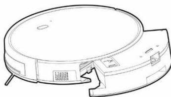
Setzen Sie den Wassertank vorsichtig in das Gehäuse des Robo-Saugers ein. Verschütten Sie den Robo-Sauger oder seine Innenteile nicht mit Wasser; Der Staubsauger ist nicht wasserdicht. Verbinden Sie es mit der Ladestation. Für beste Ergebnisse beim Wischen mit Wasser empfehlen wir, diese Funktion in einem Raum zu verwenden und dann in einen anderen Raum zu wechseln.
