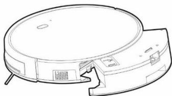
Introduceți cu atenție rezervorul de apă în corpul aspiratorului robot. Nu udați aspiratorul sau partea sa interioară cu apă, aspiratorul robot nu este rezistent la apă. Conectați-l la stația de încărcare.
