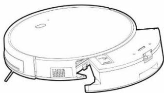
Oprezno umetnите spremnik za vodu u tijelo robotskog usisavača. Ne polijevajte robotski usisavač ni njegov unutarnji dio vodom jer nije vodootporan. Spojite ga na stanicu za punjenje. Želite li postići što bolji rezultat brisanja vodom, preporučamo da tu funkciju upotrijebite u jednoj prostoriji, a zatim se premjestite u iduću prostoriju.
