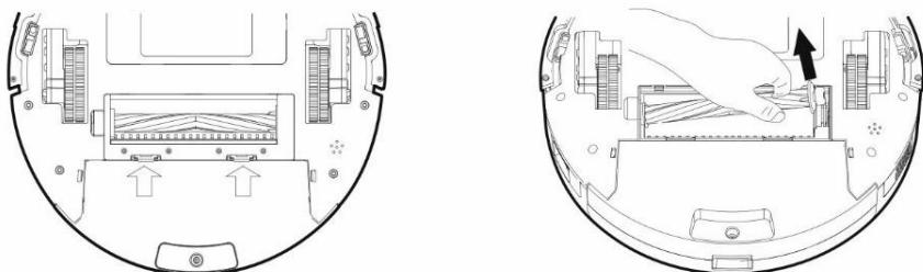
Hlavní středový čistící kartáč vyjměte stisknutím obou úchytek na krytu kartáče. K odstranění vlasů zamotaných do hlavního kartáče použijte čisticí nástroj. Udržujte středový čistící kartáč bez většího množství vlasů, prachu, bavlny apod.
