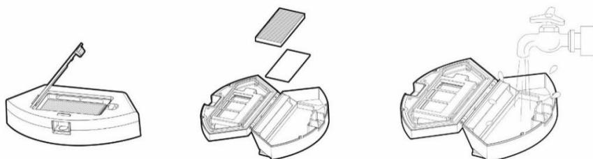
Vycistěte HEPA filtr pravidelně dle míry jeho znečištění, minimálně jednou týdně, prachovým štětcem nebo vysajte klasickým vysavačem.
