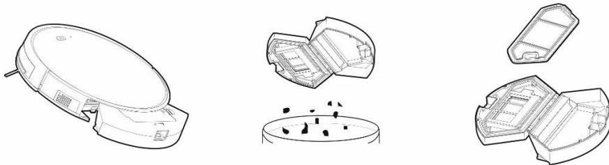
Naciśnij przycisk zwalniający, aby wyjąć pojemnik na kurz i opróżnij do pojemnika na śmieci.
